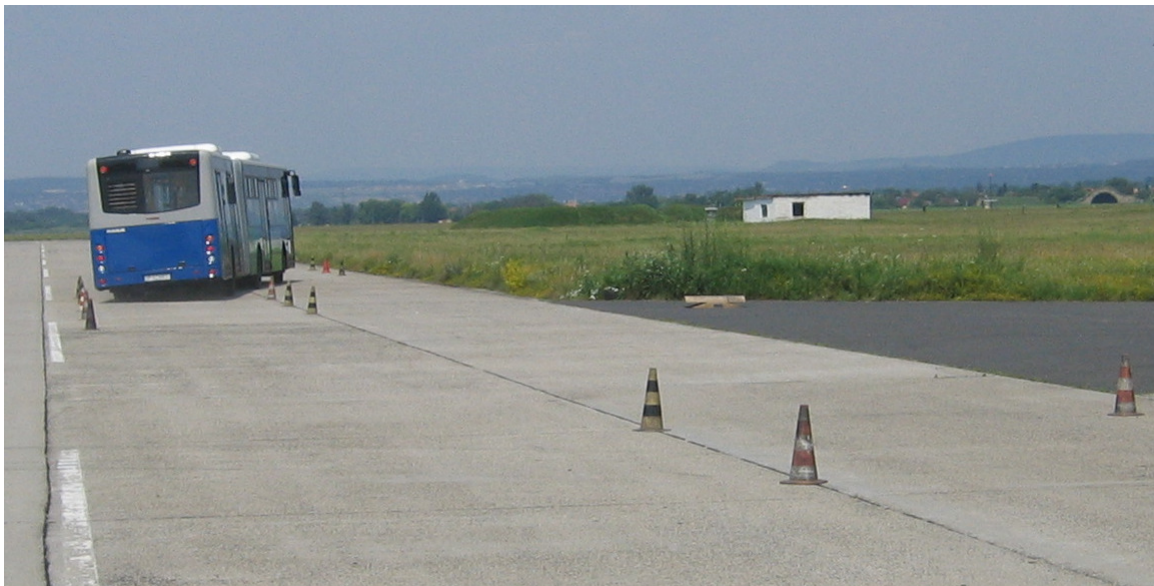
Kettős sávváltási kísérletsorozat a bójadöntések előfordulásáig fokozatosan növelt sebességgel
